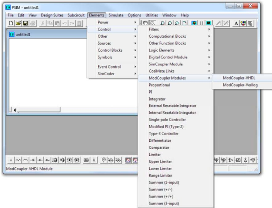
Fig. 2: ModCoupler-VHDL module menu.
